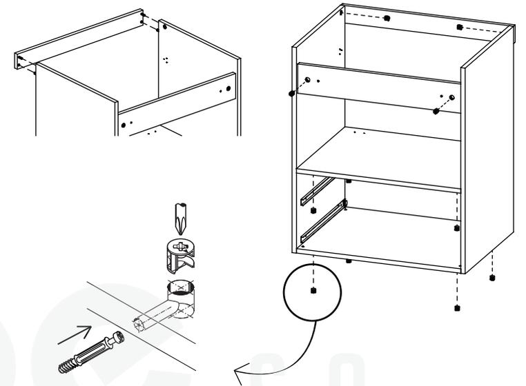
RECLINAR EL MUEBLE Y COLOCAR LAS PATAS, AJUSTAR LOS 4 TORNILLOS.
