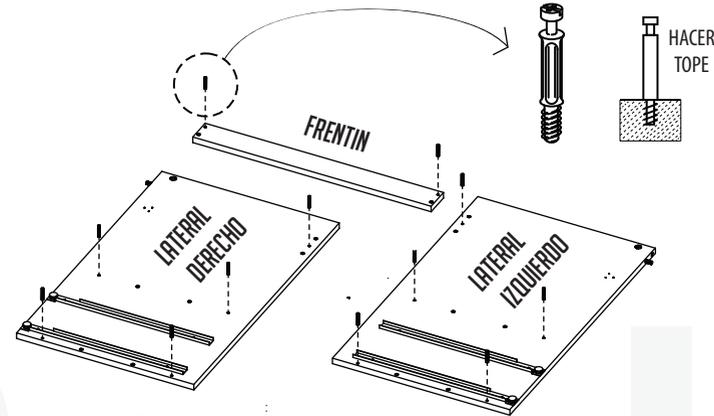
APOYAR UNO DE LOS LATERALES SOBRE LA MESA CON LOS AGUJEROS Y CORREDERAS HACIA ARRIBA. COLOCAR EL TRAVESAÑO TRASERO, EL ESTANTE Y LA BASE. LUEGO MONTAR EL OTRO LATERAL A TOPE.
